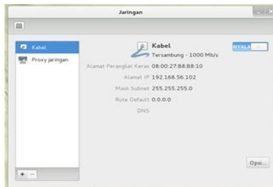
**Gambar 23.** Pengaturan konfigurasi alamat IP melalui konfigurasi Jaringan (Network)
